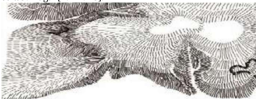
4-rasm. Shtrix usuli. Yonbag'ir qancha qiya bo'lsa, shtrixlar shuncha zich berilgan
