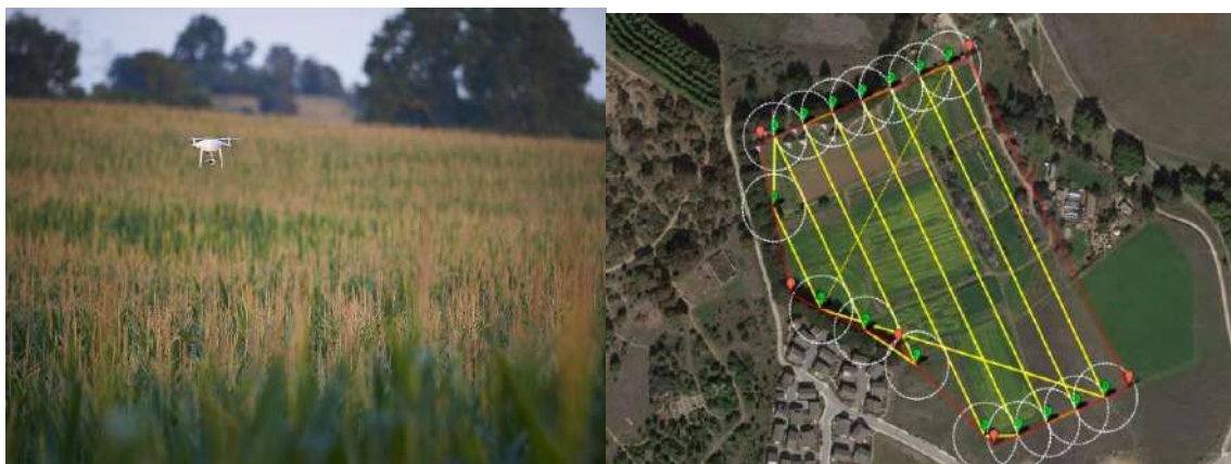
1-rasm. Qishloq xo'jaligida uchuvchisiz uchish apparatidan (Agrodron) avtomatik tarzda aerosur'atga olish
